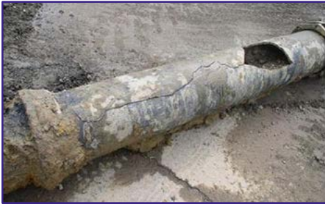
Şekil 5.6. Su koçu darbesi nedeniyle kırılan bir boru
