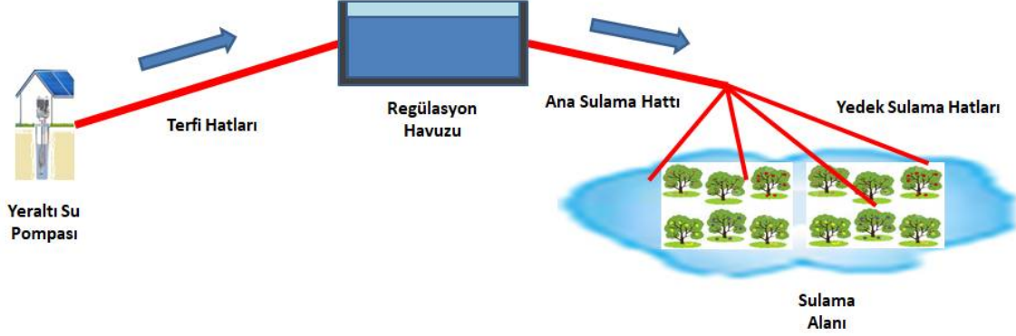
Şekil 8. YAS Sulamasında Terfi İstasyonu – Regülasyon Havuzu Kullanımı. Kaynak: SYGM (2020).
