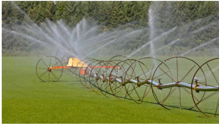
Şekil 14. Wheel Line Yağmurlama Sulama Uygulaması.
