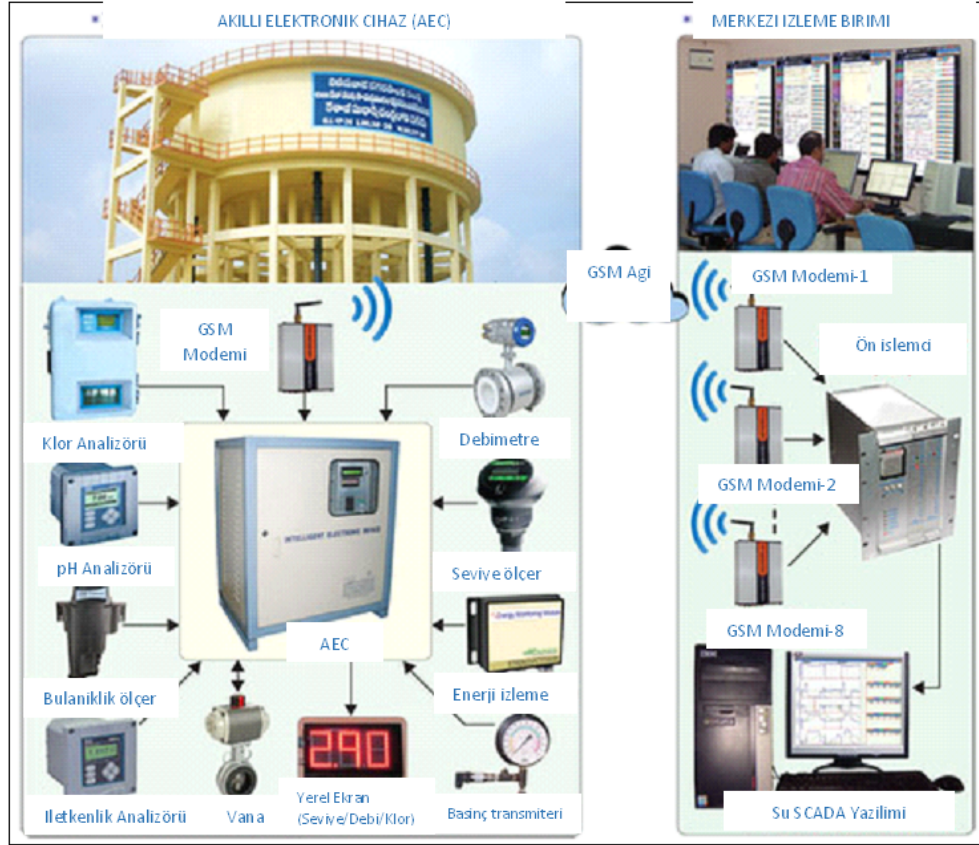
Şekil 19. Su temini sistemi SCADA'sındaki tipik unsurlar.
