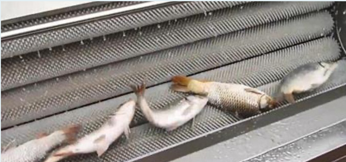
Şekil-8 Pul Ayıklama İşlemi İçin Kullanılan Döner Tambur Ekipmanı (URL - 5, 2021)
